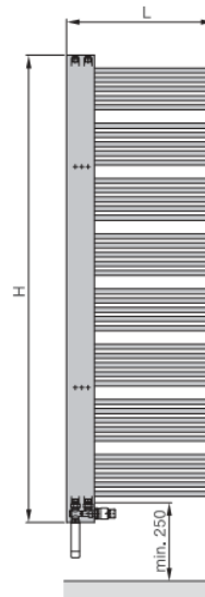
Zasilanie mix: rury w prawą stronę
